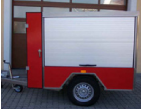
Hänger für Tragkraftspritze, Eigenbau von Josef Dorn, 1999
