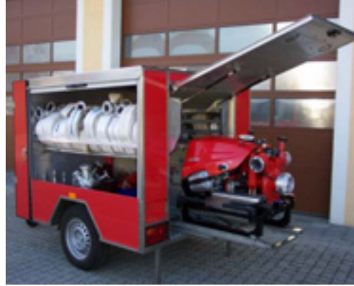
Hänger für Tragkraftspritze, Eigenbau von Josef Dorn, 1999
