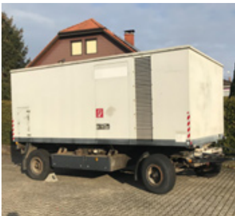
Notstromaggregat, 70 kVA, 1989, angeschafft 2022
